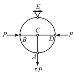
عضوهای  $CD$  و  $BC$  در یک راستا هستند. بنابراین با توجه به نحوه اتصال این اعضاء به عضو  $AC$  در گره  $C$  در راستای آنها نیست) و این‌که بار خارجی به گره  $C$  اعمال نشده است، می‌توان گفت  $AC$  یک عضو صفر نیرویی می‌باشد. ( $F_{AC} = 0$ )
