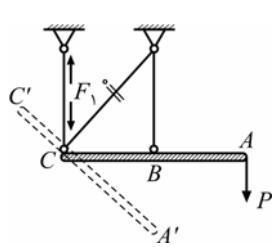
تغییر طول کابل ۲ mm می‌باشد، لذا نیروی ایجاد شده در آن به صورت زیر قابل محاسبه است:
