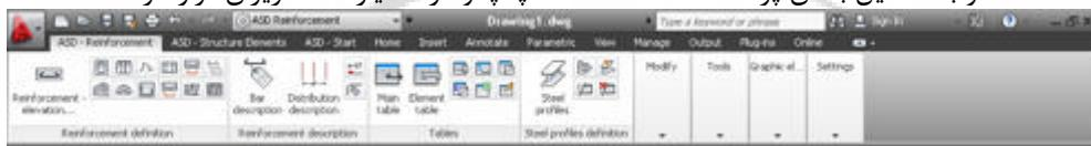
حالت AutoCAD Structural Detailing - Steel، ابزارهایی برای خلق نقشه جزئیات سازه فولادی را دربر دارد، که شامل مجموعه کاملی از گزینه‌هایی برای ترسیم دتایل‌های یک نقشه سازه فولادی می‌باشد، که با توجه به نیازهای مهندس طراح، آنها تنظیم می‌شوند و امکان ترسیم اشیا به صورت بصری را فراهم می‌سازند؛ که به چندین بخش برای این منظور تقسیم می‌شود:
